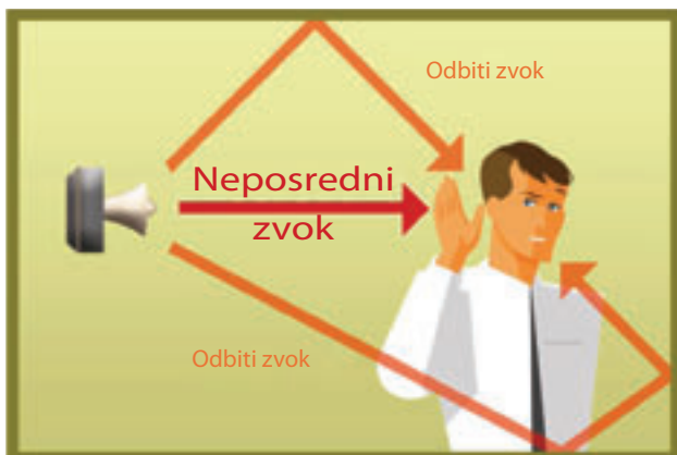
Slika 3.1: Zvok, ki ga oddaja akustični vir, se odbija od sten delovnega mesta. Izpostavljenost delavca je kombinacija odbitega zvoka in neposrednega zvoka.
