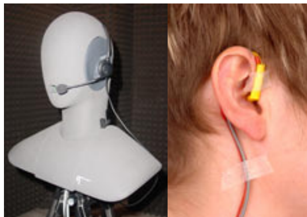
Slika 2.13 Meritve hrupa pri ušesu z uporabo metod HATS in MIRE; z dovoljenjem Health and Safety Executive – Velika Britanija Simulator glave in trupa (vir HEAD Acoustics GmbH, Nemčija) MIRE
