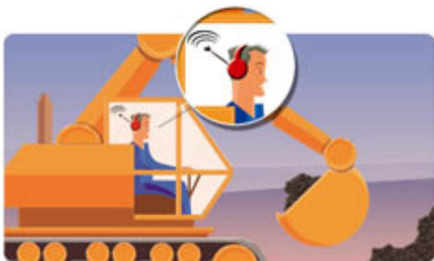
Slika 5.11 Na delovni postaji, kjer je potrebno sporazumevanje, delavec uporablja naušnike, opremljene z elektronskimi komunikacijskimi sistemi
