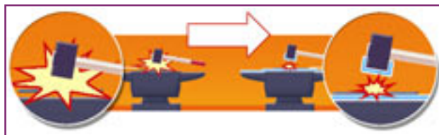
Slika 4.8 Viri, ki se prenašajo skozi trdno strukturo: ukrepanje glede sil ali strukture opreme.
