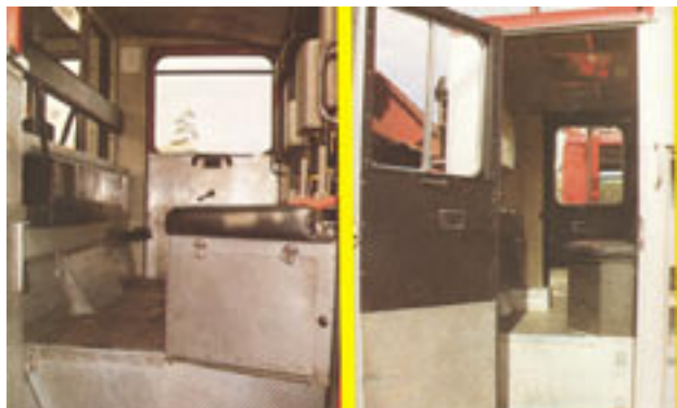
Slika 4.16 Prevoz – hrup v kabini tega cestnega vozila za prevoz osebja je zmanjšan tako, da so tla in stranske stene prevlečeni s steklenim vlaknom, obdanim z jekleno pločevino, druge površine pa z absorpcijskim materialom © z dovoljenjem Health & Safety Executive – Združeno kraljestvo
